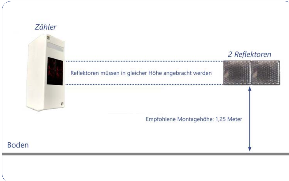
Anbringung des Zählers und der Reflektoren
