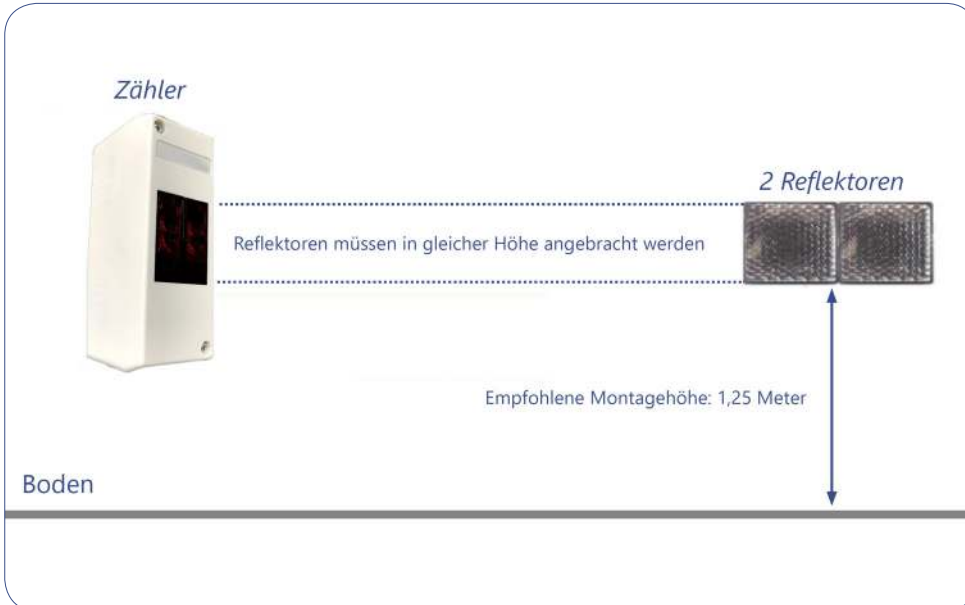
Anbringung des Zählers und der Reflektoren
